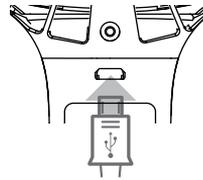
1. USB케이블을 노트북 또는 데스크탑, 인증된 휴대폰 충전기(정격 5V, 0.5~1A)에 연결하고, 반대쪽 단자를 USB 충전단자에 연결하면 적색램프가 켜지면서 충전이 시작됩니다.
