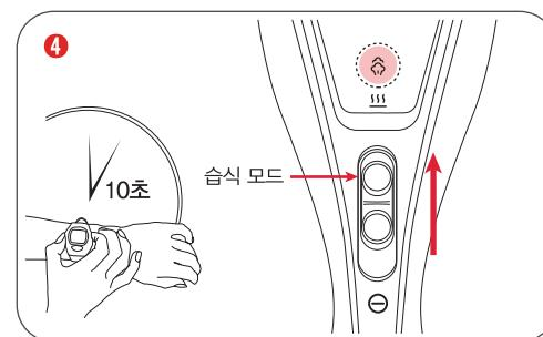
작동 스위치를 두번 위로 밀면 습식 모드이며, 습식 모드 표시등이 켜집니다. 약 10초 후 스팀이 배출되며 습식 모드로 사용할 수 있습니다. 습식 모드 사용 종료 시 작동 스위치를 OFF 위치에 놓습니다. 사용이 끝난 후 플러그를 뽑아 주십시오.
