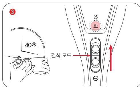
작동 스위치를 한번 위로 밀면 건식 모드이며, 건식 모드 표시등이 깜빡입니다. 스팀 배출구 열판의 가열이 시작되며, 약 40초 후 표시등이 지속적으로 켜지고, 건식 모드로 사용할 수 있습니다. 건식 모드 사용 종료 시 작동 스위치를 OFF 위치에 놓습니다.
