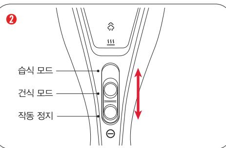
전원 플러그를 꽂은 후 작동 스위치를 위 아래로 밀어 사용합니다. 의류 종류에 따라 습식 모드(열판+스팀 작동), 건식 모드(열판 작동) 중 원하는 작동 모드를 선택해 사용하십시오.
