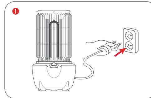
사용 전 제품을 평평한 곳에 놓아 주십시오. 바닥이 불안정한 곳에 놓으면 전도안전스위치가 작동되지 않아 제품이 작동하지 않습니다. 설치 후 전원 플러그를 콘센트에 연결해 주십시오.
