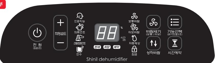
초기 전원 버튼을 누르면 바람세기는 보통, 희망습도는 50%로 자동 설정되며, 현재 습도는 주위 습도에 따라 자동 표시됩니다. (현재 습도는 초기 전원을 켜 후 약 1분 후에 표시됩니다.) ※ 이후 사용 시에는 바로 전 사용했던 선택 기능이 기억되어 디스플레이에 표시됩니다. 전원 버튼을 3초간 누르면, 버튼 잠금을 설정 또는 해제할 수 있습니다.
