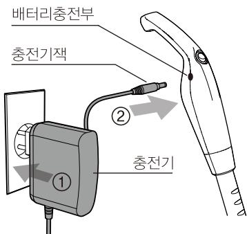
\* 손잡이 오른쪽에 배터리 충전부가 있습니다. 이곳에 충전기잭을 꽂아 배터리를 충전하십시오.
